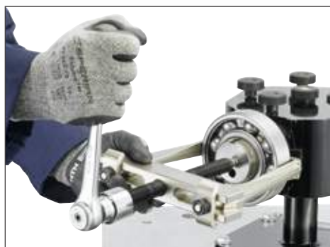
Extracción con sujeción exterior
